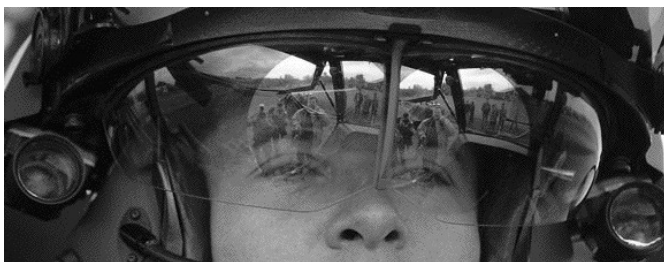
Figure 8. Système TopOwl (Thales) ; on remarque le combineur visière et les tubes de vision de chaque côté du casque, au niveau de la ligne des yeux
